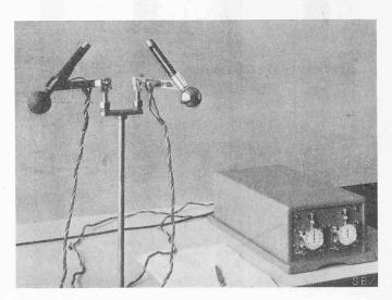
Bild 8. Entwärmungsmesser Sulzer. Links Kata-Thermometer, rechts elektrische Registrierung der Abkühlzeiten
