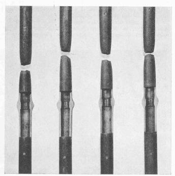
Bild 9. Zerreissproben an Rohrausschnitten mit Schweissungen
