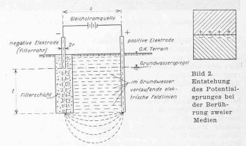
Bild 1. Schema eines elektrosmotisch betriebenen Filterbrunnens
