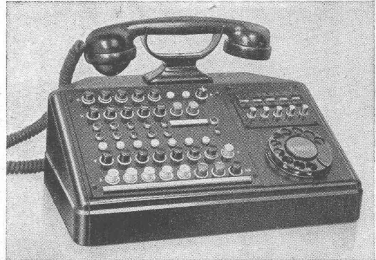
Abb. 2 Fünfteilige ferngesteuerte Vermittlungsstation
