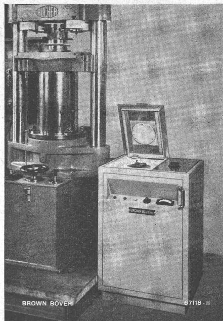
Bild 4. Mit diesem 1-kW-Hochfrequenz-Röhrengenerator wird das in der Kunststoff-Fabrikation verwendete Presspulver in kürzester Zeit durchwärmt und plastisch. Der anschliessende Pressprozess wird abgekürzt und die Produktion gesteigert.
