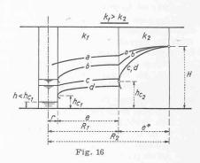
d) Ecoulements à travers des zones de perméabilités différentes (fig. 15 et 16)
