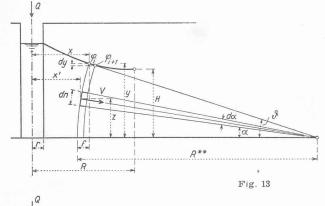
sibles en pareil cas, on voit que la section critique peut se trouver soit au bord de la tranchée de drainage, soit à la limite des différents matériaux constituant la digue.
