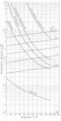
Bild 7. Kinematische Zähigkeiten von Luft, Wasser und verschied. Oelsorten Bild 8 (rechts). HD-Speicherpumpe der Etzelwerk A.-G., Altendorf. 1:56
