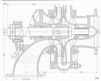
Bild 5. Modell der Etzel-Speicherpumpe, Ausführung für Wasser
