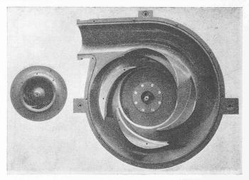
Bild 4. Sulzer-Hochdruckventilator aus Holz, geometrisch ähnlich zur Pumpe Bild 1
