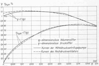
Bild 2. Charakteristiken der Zentrifugalpumpe Bild 3 bzw. des Ventilators Bild 4
