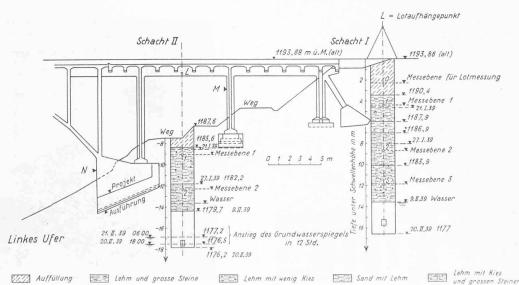
Bild 7. Anordnung der Sondierschächte I und II. — Masstab 3:1000
