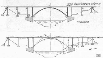
Bild 4. Rissplan und Verschiebungszustand
