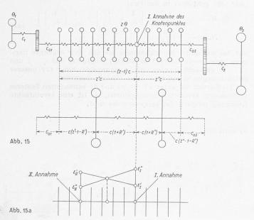
Wenn sich der Knotenpunkt in Abb. 13 rechts befindet, so ist die Unterteilung der Gesamtelastizität  $c\left(z-1\right)$  der Kurbelwelle durch die Ersatzmasse  $z_{\Theta}$  gegeben durch die Werte:
