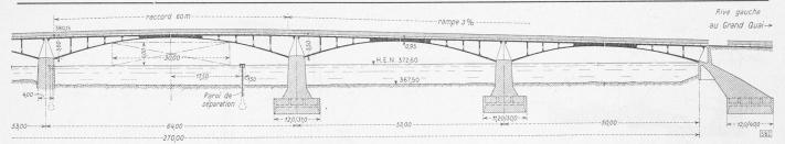
Bild 10. Neue Mont-Blanc-Brücke; Längsschnitt der linksufrigen Hälfte 1:1000. Leichte Eisenbeton-Gewölbe mit kastenförmigem Querschnitt. Schiffahrt-Profil der Mittelöffnung 30 imes 6 m
