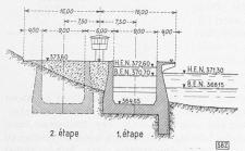
Maschinenhauses Coulouvrenière, 1:800. projektiert unter Mitarbeit der Firma Escher Wyss, Zürich Bild 15 (links). Querschnitt der Schleusen, Masstab 1:800
