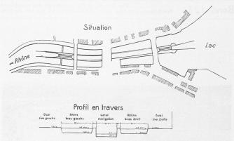
Bild 6. Vertiefte Mittelrinne für die Schiffahrt in der Rhone: In der obern Schleuse würden die Schiffe so tief abgesenkt. dass sie unter den Brücken hindurch kommen, in der untern würden sie wieder auf Höhe des Rhonespiegels gehoben
