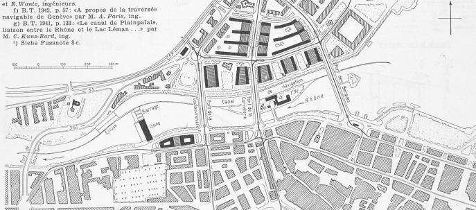
Bild 8. Entwurf der Ingenieure SCHUBERT & SCHWARZENBACH und Dr. CH. JAEGER, Zürich. — Masstab 1:10000 Ideallösung mit Schiffahrt in der Rhone, Neu-Organisation des Strassenbahn- und Autoverkehrs unter Sanierung des Quartiers St. Gervais. Neuer Pont des Bergues unterhalb der Rousseau-Insel als Ersatz der ungenügenden Mont Blanc-Brücke. Totalkosten rd. 300 Mio Fr.
