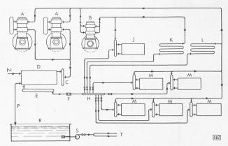
Bild 8. Schema des Kältemittelkreislaufes.
