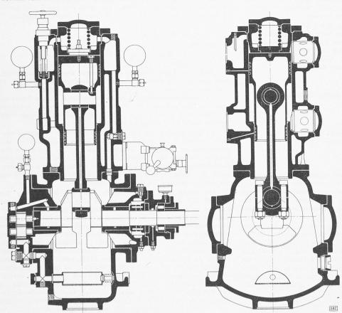
Bild 11. Einzylindriger, zweistufiger Sulzer-Ammoniakkompressor, Längs- und Querschnitt, Masstab 1:15
