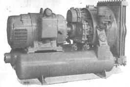
Luftgekühlter Baukompressor 4,5 m<sup>3</sup> pro Min.
