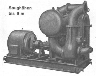
Leistungen 1 bis 500 Liter/Sek. Kein Bodenventil. Keine Klappe im Saugstutzen. Keine Hilts-Vakuum-Pumpe, Jederzeitiges automatisches Ansaugen auch nach Lufteintritt im Saugrohr. Keine reibenden, sich abnützenden Dichtungsflächen, daher unempfindlich, gegen Sand, Schlamm und Kies.
