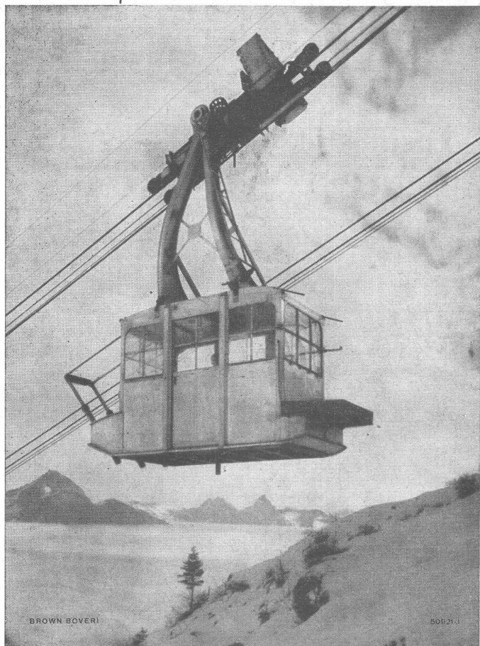
Die Schwebebahn Beckenried-Klewenalp ist mit einem Gleichstrommotor von 82 kW ausgerüstet
