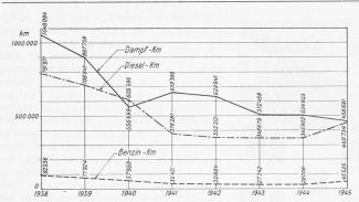
Bild 1. Km-Leistungen der konzessionierten Schiffahrts-Unternehmungen während der Jahre 1938 bis 1945
