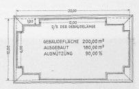
Bild 7. Ausnützungsmöglichkeit des ausgebauten Mansarddachs nach heutigem Baugesetz
