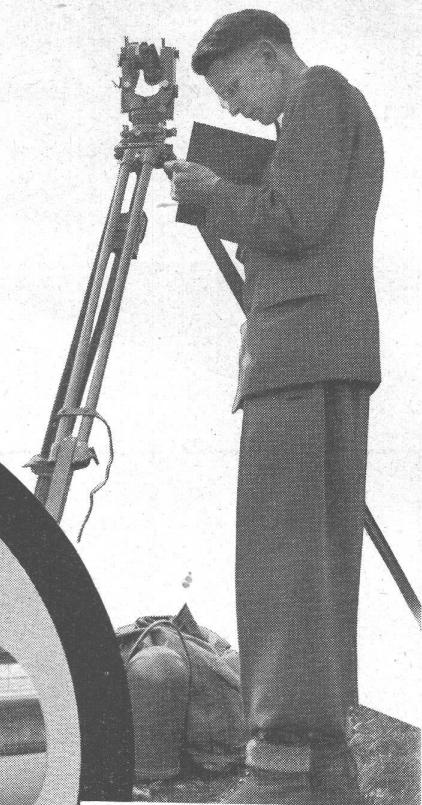
Der **Repetitions-Theodolit Wild T1**, den wir hier sehen, ist, wie auch der Universal-Theodolit Wild T2, mit der bekannten Wild'schen Stehachse ausgerüstet. Die Stehachse bildet den Hauptbestandteil des Instrumentes. Sie ist zylindrisch, mit einer Führung unten. Eine konische Erweiterung der Achsbüchse nimmt die Kugeln auf, die den ganzen oberen drehbaren Teil des Wild Theodolits tragen und zentrieren. Diese Anordnung sichert einen stets regelmässigen Gang ohne irgendwelche Nachjustierung.
