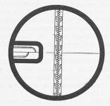
kann. Es besteht so Gewähr dafür, dass im Zeitpunkt der Ablesung die Ziellinie tatsächlich horizontal ist. Das Instrument eignet sich für alle Nivellemente mittlerer Genauigkeit und für die Kontrolle von Montagen. Der mittlere Kilometerfehler für einfaches Nivellement beträgt etwa  $\pm 2$  mm.
