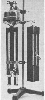
Bild 1. Aspirationspsychrometer links nach Assmann, rechts nach Angaben des Verfassers
