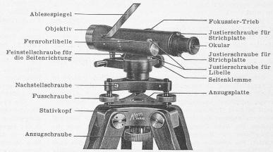
Bild 28. Kern-Nivellier-Instrument NK 1
