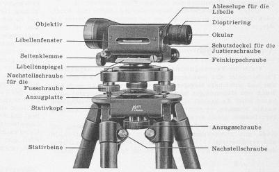
Bild 29. Kern-Nivellier-Instrument NK 2
