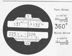
Bild 23. Ablesung von Horizontal- und Vertikalkreis beim Kern-Theodolit DK2
