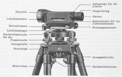
Bild 29. Kern-Nivellier-Instrument NK 2
