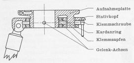
Bild 17. Kipptellerstativ der Kern-Theodolite. Die Aufnahmeplatte für den Theodolit bildet der im Stativkopf kardanisch angebrachte Kippteller. Er kann nach allen Richtungen gekippt und in beliebiger Stellung auf dem Stativkopf festgeklemmt werden.
