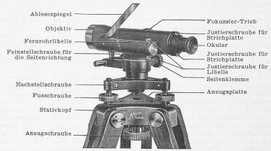
Bild 28. Kern-Nivellier-Instrument NK 1
