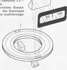
Bild 18. Doppelkreise und ihre Ablesung. Auf dem selben Kreis werden zwei Teilungen mit verschiedenen Durchmessern und Intervallen aufgetragen. Zur Ablesung werden gegenüberliegende Kreisstellen verschiedener Kreise zu einem Bild vereinigt
