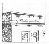
Fugen mit Zementmörtel: Flecken und Putzschäden
