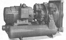
Luftgekühlter Baukompressor 4,5 m³ pro Min.
