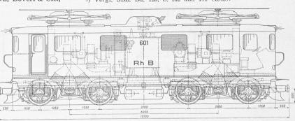
Typenskizze rd. 1:200 der B<sub>0</sub> + B<sub>0</sub>-Lokomotive der Rhätischen Bahn
