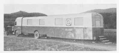
Bild 3. Der ausgezogene Rollkasten als Umkleideraum
