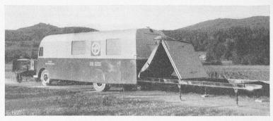
Bild 1. Der Boden des Auskleideraums wird abgeklappt
