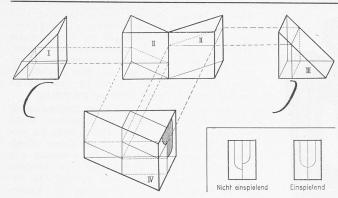
Bild 9. Einstellung auf Koinzidenz der zwei Blasenenden einer Libelle. Die Skizze zeigt eine der verschiedenen Möglichkeiten für die Anordnung des Prismensystems. Die Vertikalebene I-II-III enthält die Axe der Libelle. Durch diese Stellung wird erreicht, dass im Ableseprisma IV die beiden Blasenenden halbiert und nebeneinander erscheinen
