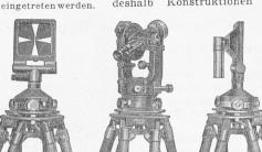
Bild 8a bis 8d. Zwangszentrierung für genaue Polygonmessung; Theodolit und Zielmarken passen genau in den selben Unterteil
