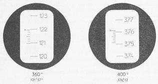
Bild 3. Kreisablesung bei einem Nivellierinstrument, links alte, rechts neue Teilung. Ablesung auf  $10^\circ$  oder auf  $10^\circ$ , Schätzung auf  $1^\circ$  oder auf  $1^\circ$
