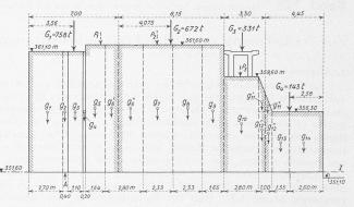
Bild 3. Zusammenfassung der 18 Vertikallasten zu vier vertikalen Einzelkräften
