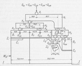
Bild 4. Zusammenfassung der vier vertikalen Einzelkräfte  $G_{1\,M}$  bis  $G_{4\,M}$  gemäss Bild 3 zu einer einzigen, resultierenden Vertikalkraft  $G_M$ .  $H_1$  bis  $H_3$  Hebel (Stahl),  $R_1$  bis  $R_7$  Rollen (Stahl),  $B_1$  bis  $B_3$  Belastungsstücke (Celluloid),  $C_1$ ,  $C_3$  Ausfüllstück zum Ausgleich (Celluloid),  $Z_1$  bis  $Z_2$  Zwischenlagen (Gummi) zur bessern Lastverteilung, W Wehrbrückenmodell (Stahl), f fest, b beweglich
