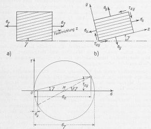
Bild 1. Spannungen  $\sigma_x$ ,  $\sigma_y$  und  $\tau_{xy}$  infolge  $\sigma_y$
