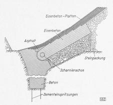
Bild 4. Querschnitt 1:250 der Herdmauer mit Scharnierstück und Anschluss der Betonplatten-Decke
