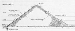
Bild 2. Querschnitt des Dammes, 1:3500
