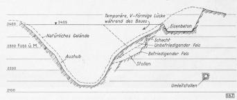
Bild 3. Längsschnitt durch die Dammkrone, 1:3500
