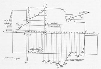
Bild 19. Schubspannungen  $au_{xy} = au_{yx}$  in den Schnitten H-H und V-V
