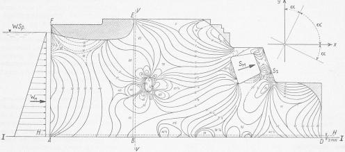
Bild 12. Isoklinen für die Belastung durch die Kräfte  $S_M$  und  $W_M$  (Isoklinen = Linien gleicher Neigung der Hauptspannungsrichtungen, also gleicher Winkel a, siehe Bild rechts oben)
