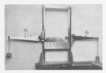
Bild 11. Versuchsanordnung.  $H_1$  Hebel für die Horizontalkraft  $W_M$  $H_2$  Hebel für die schräge Kraft  $S_M$
