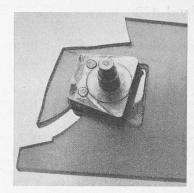
Bild 5. Bruch des Modellversuchstabes bei 300 kg Zuglast
