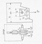
Bild 4. Günstigste Befestigungsart der Konsolen «K». 8 Trapez aus Stahl, C Trapez aus Celluloid, N Niet
