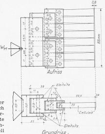
Bild 10, Tatsächlich ausgeführte Belastungsvorrichtung
