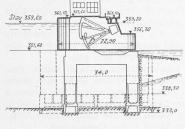
Bild 1. Anordnung des Stauwehrs, Masstab 1:1000
