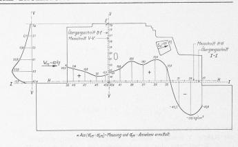
Bild 16. Hauptspannungssummen  $\sigma_{1M}+\sigma_{2M}$  für die Schnitte H-H und V-V
