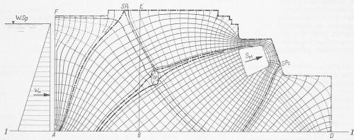
Bild 13. Hauptspannungstrajektorien für die Belastung durch die Kräfte  $S_M$  und  $W_M$ . Mittelstark ausgezogen: Hauptspannungsrichtung  $s_1$ ; schwach ausgezogen: Hauptspannungsrichtung  $s_2$  — - — Grenztrajektorien  $S_1$ , — Grenztrajektorien  $S_2$
