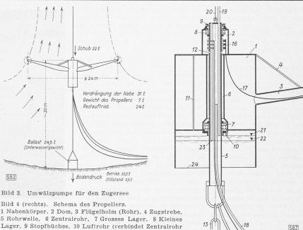
Lager. 9 Stopfbüchse, 10 Luftrohr (verbindet Zentralrohr mit Taucherglocke), 11 Luftrohr (sichert Taucherglocke
