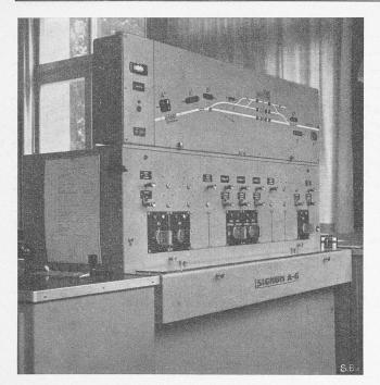
Bild 4. Neuster Stellwerkapparat zur elektrischen Fernbedienung von Weichen und Signalen. In der Mitte zwei Signalschalter, links und rechts davon Weichenschalter
