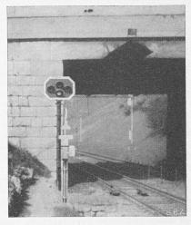
Bild 11 (rechts). Dreibegriffiges Blocksignal bei Zürich-Winkingen, dayor
