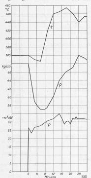
Bild 5. Verhalten bei plötzlicher Belastung
