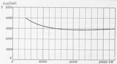
Bild 3. Spezifischer Dampfverbrauch des Turbo-Generators
