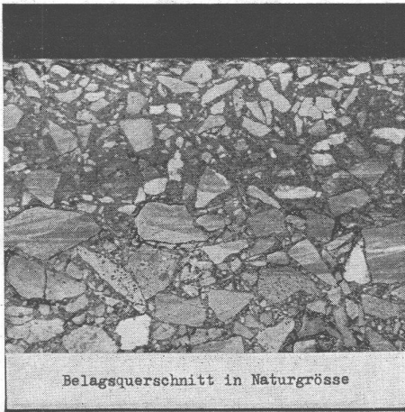
Zweischichtiger bituminöser Spezialbelag
