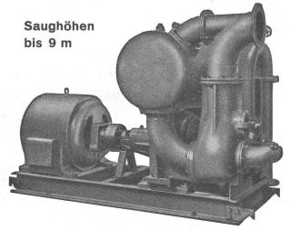
Leistungen 1 bis 500 Liter/Sek. Kein Bodenventil. Keine Klappe im Saugstutzen. Keine Hilts-Väkuum-Pumpe. Jederzeitiges automatisches Ansaugen auch nach Lufteintritt im Saugrohr. Keine reibenden, sich abnützenden Dichtungsflächen, daher unempfindlich, gegen Sand, Schlamm und Kies.
