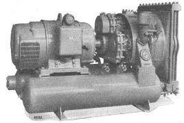
Luftgekühlter Baukompressor 4,5 m³ pro Min.
