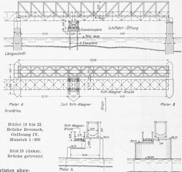
Nachdem der vordere, obere Teil des Schiffsgerüstes abgebrochen war, starteten die frei gewordenen Schiffe erneut zur Talfahrt und brachten am 26. Februar den zweiten Brückenteil nach Chalampé, der mit ähnlichen Operationen an seinen neuen Bestimmungsort gebracht wurde. Das Einfahren des Stosses ging leicht; am 5. März konnten die Schiffe wegfahren, bis zum 15. März waren die rd. 1000 Stossnieten, meistens 26 mm  $\emptyset$ , geschlagen.
