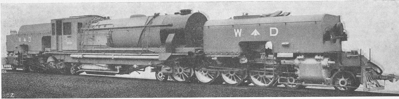
rung, verkehren. Um dieser Forderung zu entsprechen, weist die erste Triebachse keinen Spurkranz auf, während das Seitenspiel des Laufgestells mit 165 mm und das der Bisselachse 70 mm beträgt. Die Daten der Lokomotive sind:
