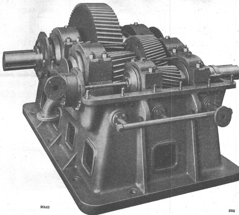
Zweistufiges MAAG - Reduktionsgetriebe für Walzwerk: 250 PS bei 750/68 U./Min. Alle Verzahnungen gehärtet und geschliffen.
