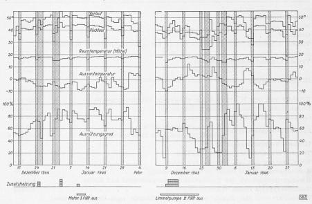
Bild 2 und 3. Ausschnitt aus dem Betriebsdiagramm der Winter 1944/45 und 1945/46 Unten: Anzahl eingesetzter Heizkessel und vorgekommene Betriebstörungen
