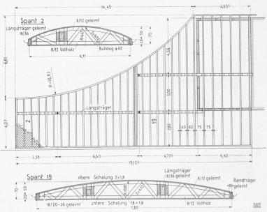
Bild 22. Rampendach Liestal. Grundriss 1:200, Spanten 1:100
