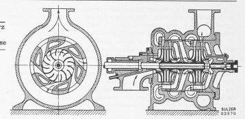
Bild 1. Sulzer Hochdruck-Zentrifugalpumpe von 1896
