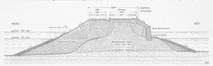
Bild 7. Querprofil 1:500 der projektierten Verbreiterung des Seedammes von Melide
