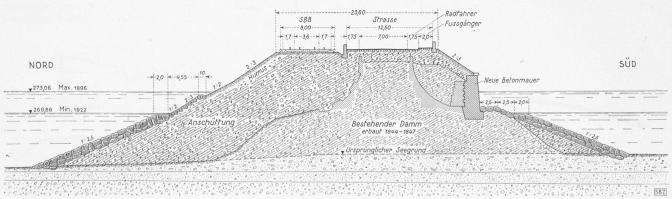
Bild 7. Querprofil 1:500 der projektierten Verbreiterung des Seedammes von Melide
