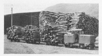
Bild 3. Holztransport mit Akkumulatorenlokomotive
