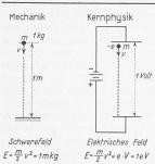
Bild 1. Energieeinheiten der Mechanik und der Kernphysik
