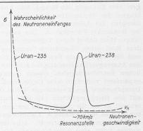
Bild 15. Die Einfangungswahrscheinlichkeit für Neutronen verschiedener Geschwindigkeiten in Uran-235 und Uran-238
