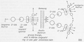
Bild 9. Die Kettenreaktion von Uran - 235
