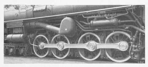
Bild 2. Linke Seite der Lokomotive mit Rückwärts-Turbine
