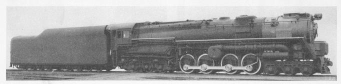
Bild 1. 6900 PS-Dampfturbinenlokomotive der Pennsylvania-Railroad, rechte Seite mit Vorwärts-Turbine
