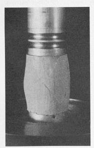
Bild 13. Verformte Tonprobe nach dem langfristigen einaxialen Druckversuch mit aktivem Vertikaldruck (Vorbelastung 2 kg/cm², Druckfestigkeit 1 kg/cm²)
