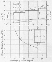
Bild 18. Ergebnisse eines Kriechversuches zur Ermittlung der Zähigkeit  $\mu$ . (Ziegeleiton, Vorbelastung 2 kg/cm³, Bruchbild vgl. Bild 13). Langfristiger Versuch mit einaxialer Druckbeanspruchung (totale Versuchsdauer 18 Tage)
