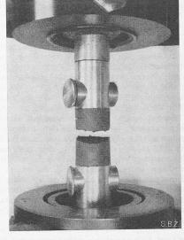
Bild 12. Vorrichtung für Zugversuche, mit zerrissener Tonprobe
