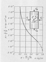
Bild 19. Zähigkeitsbestimmung eines Gehängetones (Bannalp) auf Grund der registrierten Verformungskurve nach Bild 15 (Vorbelastung 4 kg/cm²). Kurzfristiger Versuch mit allseitiger Beanspruchung (totale Versuchsdauer 48 min, Bruchbild vgl. Bild 14)
