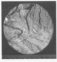
Bild 12a. Bruchfläche der zerrissenen Probe (vgl. Bild 12). Man beachte die blättrige Struktur, bedingt durch die horizontale Orientierung der Tonblättchen bei der Verdichtung der Probe
