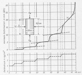
Bild 15. Registrierte Verformungskurve einer mit 4 kg/cm² vorbelasteten Tonprobe (Bannalpton). Versuchsanordnung mit zunehmendem Seitendruck ( $\sigma_{II}$ ) bei konstantem Vertikaldruck ( $\sigma_{III}$ )
