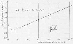
Bild 21. Einfluss des Anmachwassergehaltes auf die Scherfestigkeit einer unter  $\sigma_{\rm I}=1~{\rm kg/cm^2}$ verdichteten Probe (Ziegeleiton)
