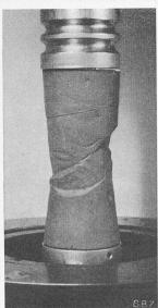
Bild 14. Verformte Tonprobe nach zweiaxialem Druckversuch mit aktivem Seitendruck (Vorbelastung 4 kg/cm²)
