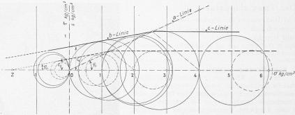
Bild 16. Darstellung der Versuchsergebnisse (Bannalpton).  $\varphi_s=25\,^\circ$ ;  $\varphi_r=10^\circ\,50'$  Kohäsion für einen Vordruck von 4 bzw. 2 kg/cm²:  $c_4=0.72$  kg/cm²;  $c_2=0.35$  kg/cm²
