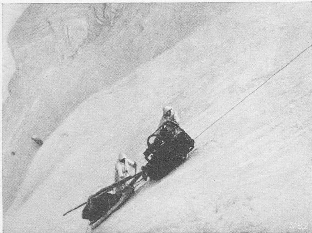
Bild 8. Die Motorschlittenwinde Typ M. S. W. zieht sich mit Zusatzlast auf Schlitten am Zugseil den Steilhang hinauf
