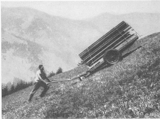
Bild 9. Barackentransport auf Anhängerwagen im direkten Zug durch Motorschlittenwinde, Typ M. S. W.
