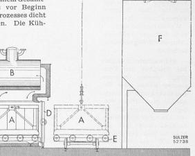
Bild 10. Sulzer-Kokskühlanlage nach dem Kammertyp. Schematischer Querschnitt. A Kokskübel, B Dampfkessel, C Gebläse, D Kühlkammertüre, E Kübelwagen, F Kokssilo, G Fahrkran
