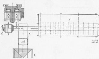
Bild 8. Sulzer-Kokskühlanlage nach dem Kammertyp. Schematischer Grundriss. 1 Trockenkühlanlage, 2 Kokskübel, 3 Transportwagen, 4 Vertikalkammerofen, 5 Fahrkran, 6 Kokssilo
