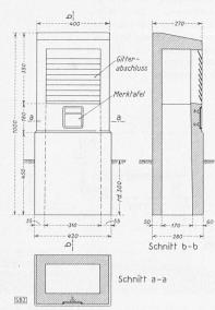
Bild 1. Betonkasten mit Jalousie-Oeffnungen, Masstab 1:20
