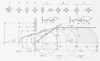
Bild 9. Beanspruchungsmöglichkeiten im Triaxialapparat zur Ermittlung des Scherdiagramms
