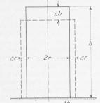
Bild 7. Verformung eines zylindrischen Körperelementes bei einaxialem Druck und freier Seitenausdehnung
