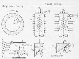
Bild 2. Ringscher- und Triaxialprinzip zur Ermittlung der Scherfestigkeit
