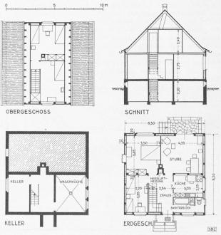
Bild 8. Grundrisse und Schnitt eines Einfamilienhauses, 1:250
